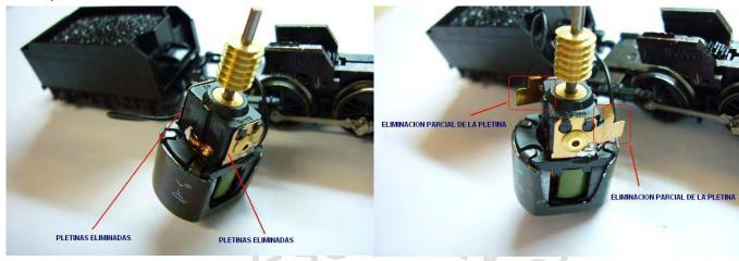
A continuación protegeremos con cinta aislante las soldaduras que lleva el motor con los cables para que este no pueda tocar en ningún momento el chasis de la maquina, y introduciremos de nuevo, forzándolo un poco y con mucho cuidado el motor en su alojamiento inicial.
