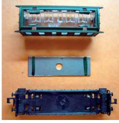
Vamos a trabajar marcando la pletina de contrapeso que lleva el coche para poder luego pasar por los dos extremos dos cables que serán los que irán para hacer la conexión con las ruedas, realizado el marcaje, lo cortaremos con una sierra los dos extremos y luego colocaremos de nuevo la pletina, pegándola a chasis.
