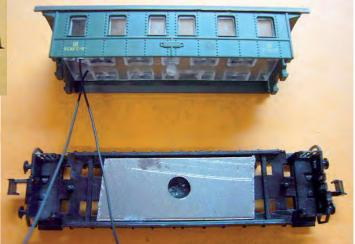
Pegada la placa, pasaremos los cables a través de los orificios que hemos realizado en la carcasa y acoplaremos el techo a esta.
