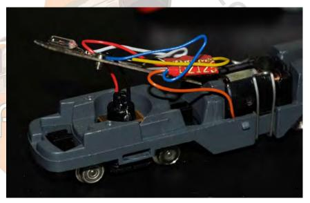
Dadas las caracteristicas de la maquina, me ha parecido lo mas eficaz retirar tambien todos los cables de conexión del motor y de las tomas de corriente de las ruedas, soldando directamente los cables del decoder que, en este caso es una DZ125 de Digitrax, sobradamente conocido para los que hayan serguido los articulos de Rafa y Toño.
